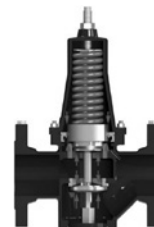
Клапан полностью закрыт (нет разбора).
